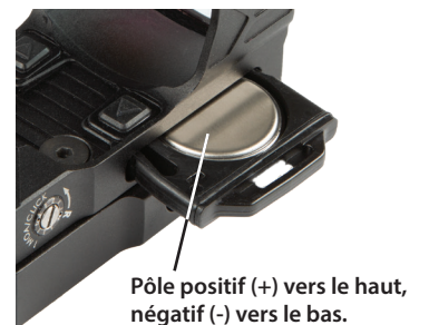
1* - Détail du logement de la pile
